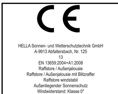
\* ... Die Windklasse 0 nach EN 13659 wird angegeben, da das Normprüfverfahren nicht geeignet ist, den Windwiderstand für die Praxis anzugeben. Die Raffstores / Außenjalousien sind je nach Ausführung und Einbau bis zu den empfohlenen maximalen Windgrenzwerten – siehe Kapitel „Verwendungszweck“ – einsetzbar.
